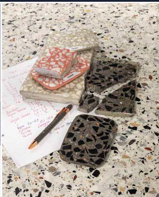
Återskapad terrazzo, eget labb, Flen
